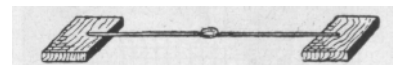
Abb. 13. Der dazugehörige Schwimmer. Die Bewegung des Schwimmers wurde auf einen Zeiger übertragen.
